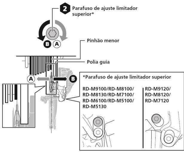
**Limite Exterior:** Ajuste de modo que o centro da polia guia esteja alinhado à face externa do pinhão menor quando visto de trás.
