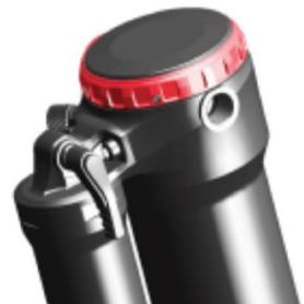
Caso a velocidade de retorno esteja baixa e o retorno for muito lento causando um descontrolo e que a bicicleta não tenha retornado o curso do amortecedor normal para transpor o próximo obstáculo, aumente a velocidade de retorno no sentido anti-horário (posição coelho).
