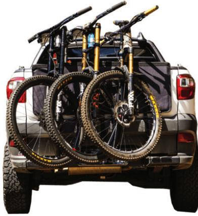
**ATENÇÃO:** Para os suportes de bicicletas de carrinhas de caixa aberta, recomendamos extremo cuidado para não haver contacto entre uma bicicleta e as outras, protegendo bem as partes da suspensão dianteira, fixar firmemente as bicicletas para evitar que caiam no trajeto, bem como utilizar uma segunda matrícula de identificação do veículo caso seja coberta a placa original do veículo.
