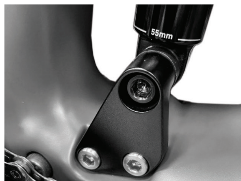
#7 Base do Shox Traseiro (2x) #5 Eixo Inferior do Shox
