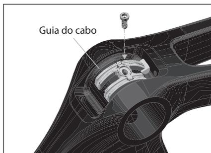
3. Coloque a guia do cabo com parafuso, e faça o aperto. Torque Máximo 5 Nm.
