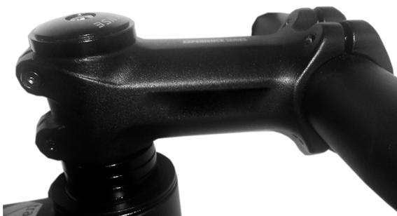
**Torque de aperto dos parafusos frontais da tampa do suporte (fixação do guidão) 5 a 6 Nm**
