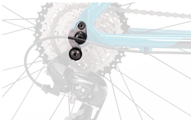
**Torque de Aperto dos Parafusos da Gancheira: 6 a 8 Nm**
